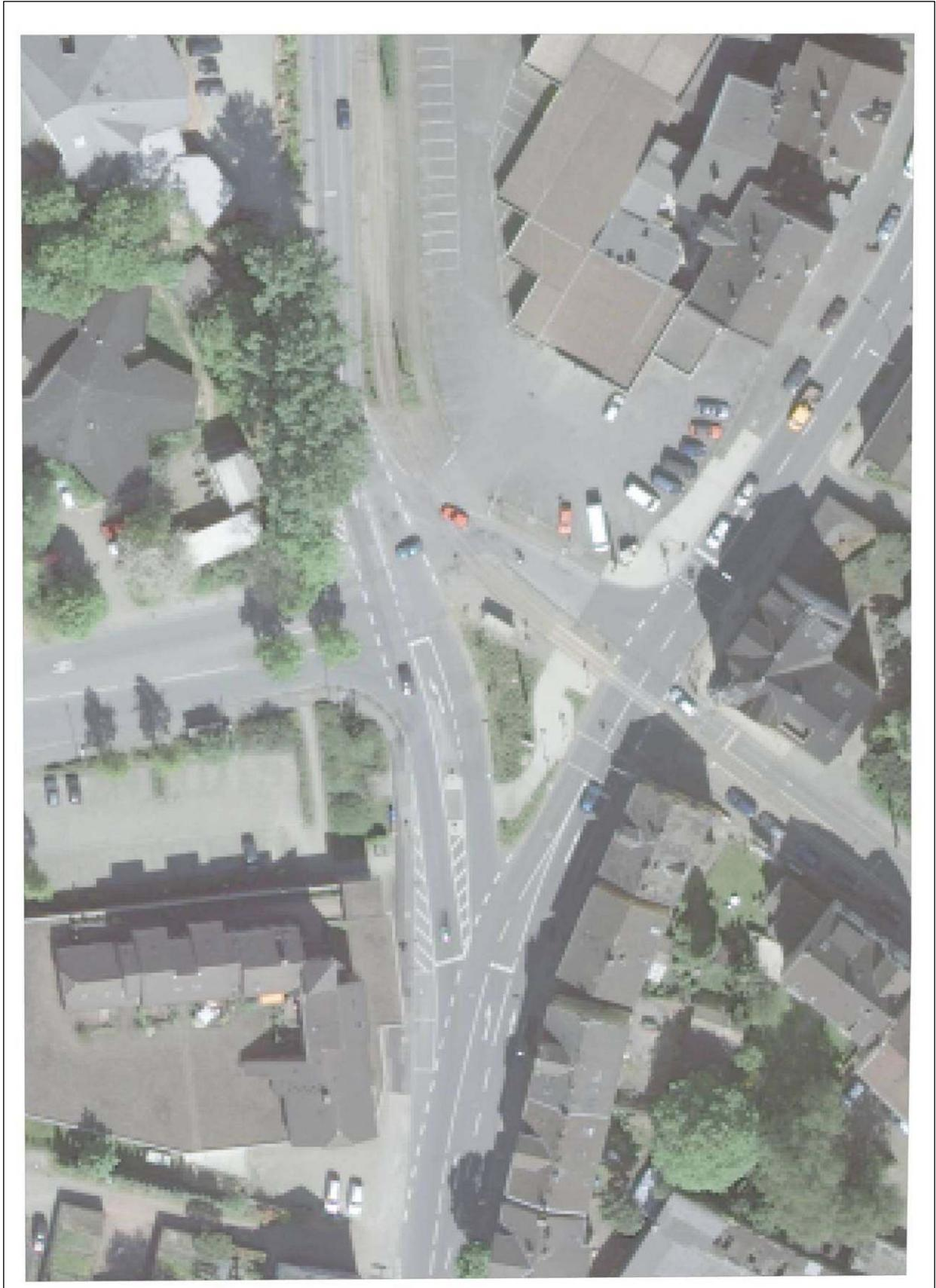
**Abb. 38:** Knoten Billerbeckstraße, Wannens, Sprockhöveler Straße, Hans-Böckler-Straße mit ungünstiger, unübersichtlicher Verkehrsführung und überdimensionierten Verkehrsflächen
